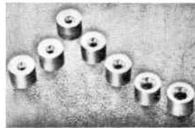
Рис. 12.4. Фильеры для волочения проволоки, изготовленные из вольфрамового твердого сплава (типа ВК) после обработки ионной имплантацией
