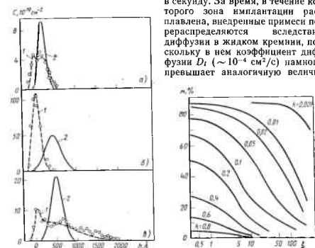
Рис. 4.2. Профили концентрации атомов С по глубине h для Те (а), Си (б), Вi (в), имплантированных в кремний с ориентацией (100) и обработанных однократным импульсом рубинового лазера. Штриховыми линиями 1 показаны данные численного расчета массопереноса при использовании коэффициента распределения на границе фаз как параметра аппроксимации, а кружками — опытные данные. Сплошные кривые 2 соответствуют профилям сразу после имплантации. Плотность энергии [24]:
